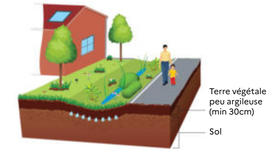
Noue d'infiltration simple © Adopta
