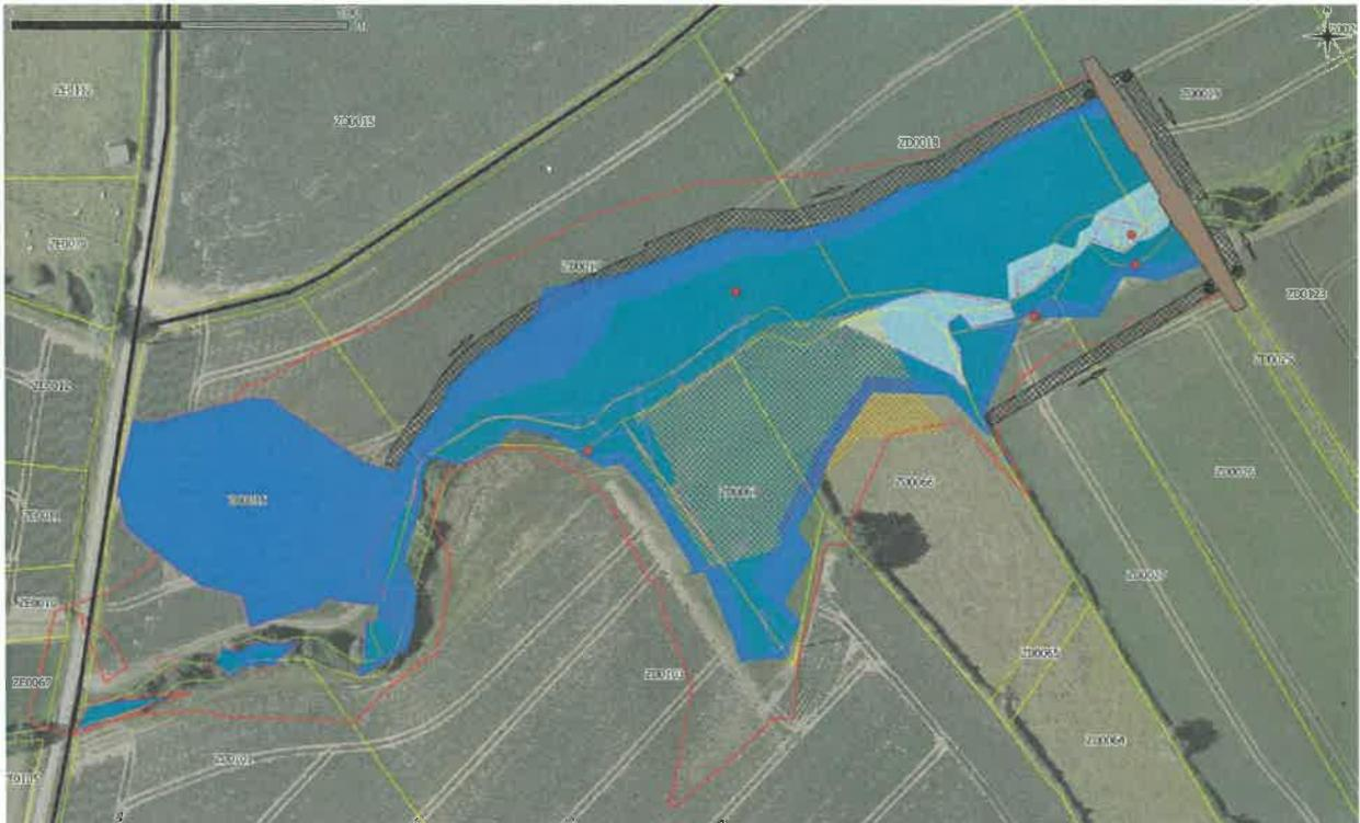
Localisation des clapets anti-retour (points rouges) et des tranchées à installer (bandes quadrillées noires)
