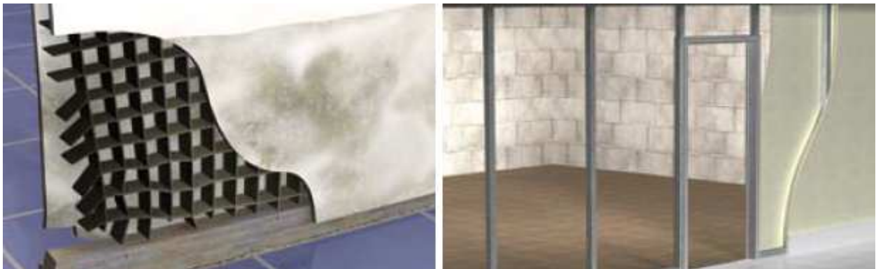
Figure 13 - À gauche, la dégradation d'une cloison alvéolée ayant été immergée ; à droite, l'adaptation au passage de l'eau via la mise en place d'une cloison sur ossature métallique
