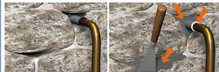
Afin d'être efficaces, les mesures présentées précédemment doivent parfois s'accompagner de la réfection des biens implantés en zone inondable. Aussi, **le traitement des joints de maçonnerie, des fissures localisées**, ainsi que **la mise en oeuvre d'un revêtement d'imperméabilisation des murs extérieurs**, permettent de s'assurer que l'eau n'envahira pas le bâtiment par le biais de petites ouvertures
