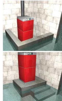
La **surélévation des équipements de génie climatique** peut avoir un coût nul selon la configuration du bâti. Cependant, la mise en place spécifique d'un support béton pour la surélévation d'une chaudière à titre d'exemple, peut représenter un coût de plusieurs centaines d'euros. Cette mesure représente néanmoins une très forte réduction de la vulnérabilité d'un bien de par la protection d'équipements coûteux et indispensables à son bon fonctionnement.
