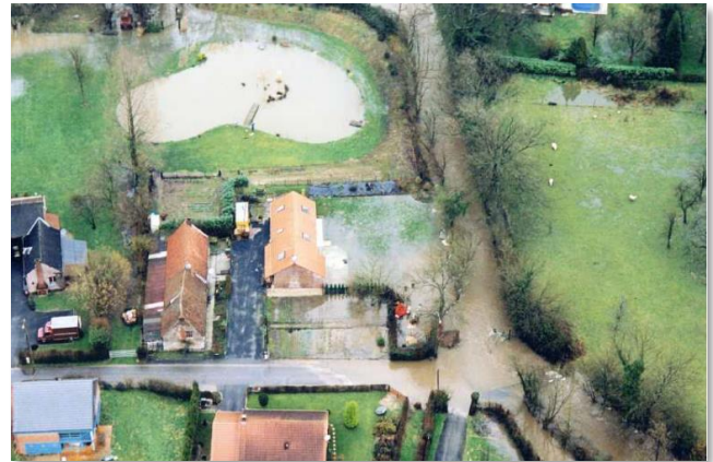
Inondations à Louvignies-Quesnoy. La présence d'une digue ceinturant le plan d'eau conduit à l'inondation de la maison située en amont
