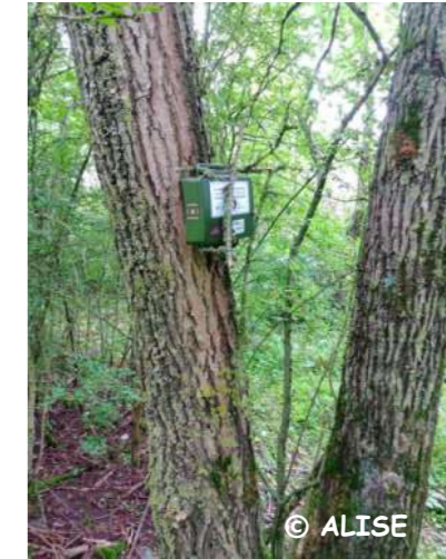
Photo 2 : Minibat utilisé sur site en août 2021
