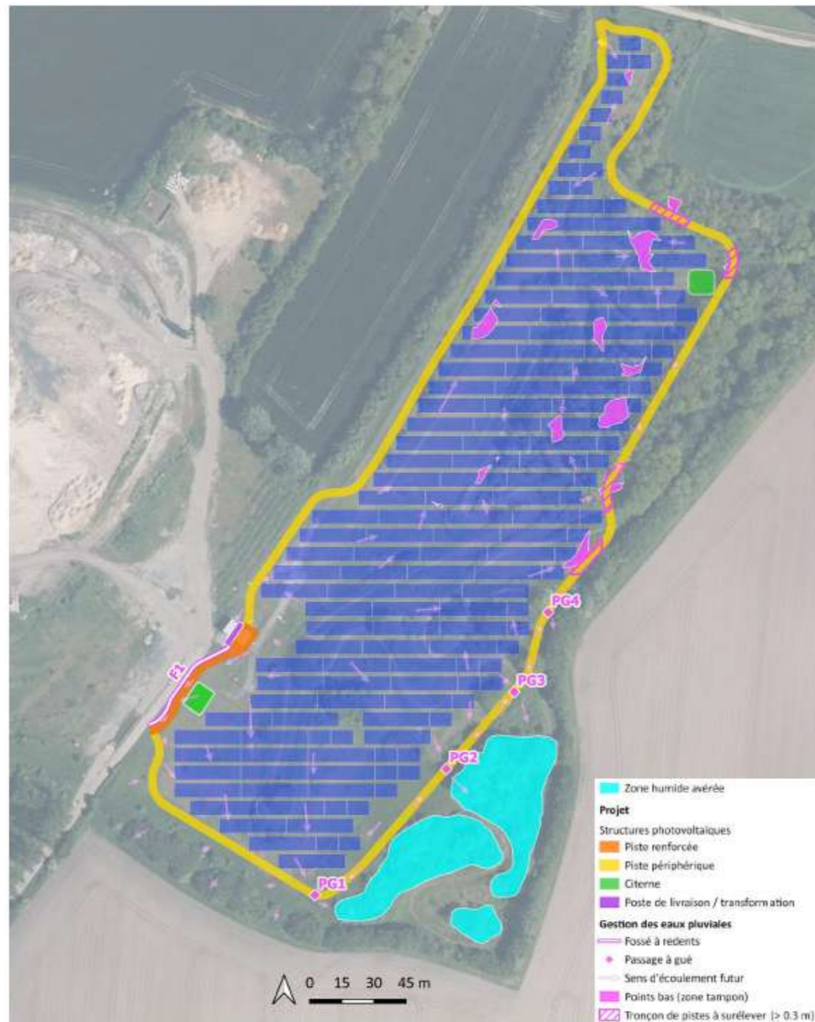
Figure 29 : Plan général des aménagements de gestion des eaux pluviales retenus Source : Etude hydraulique - INGETEC
