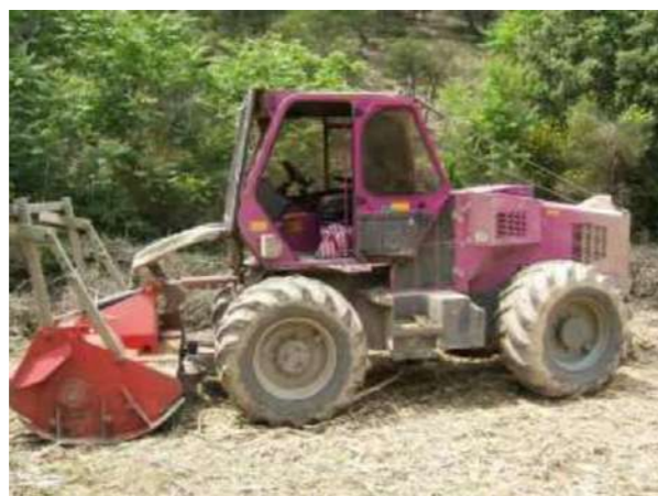
Figure 33 : Exemple de tracteur équipé d'un broyeur forestier Source : Société forestière de la Durance, 2016
