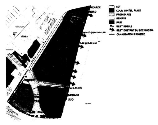
Un exutoire avec débit de fuite l'imité à 1,93 l/s sera réalisé à l'Ouest vers le réseau communautaire existant de la rue Sadi Carnot et un exutoire avec débit de fuite (imité à 19,59 l/s sera réalisé à l'Est vers le canal de la Deûle.
