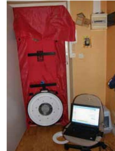
Test de perméabilité à l'air
