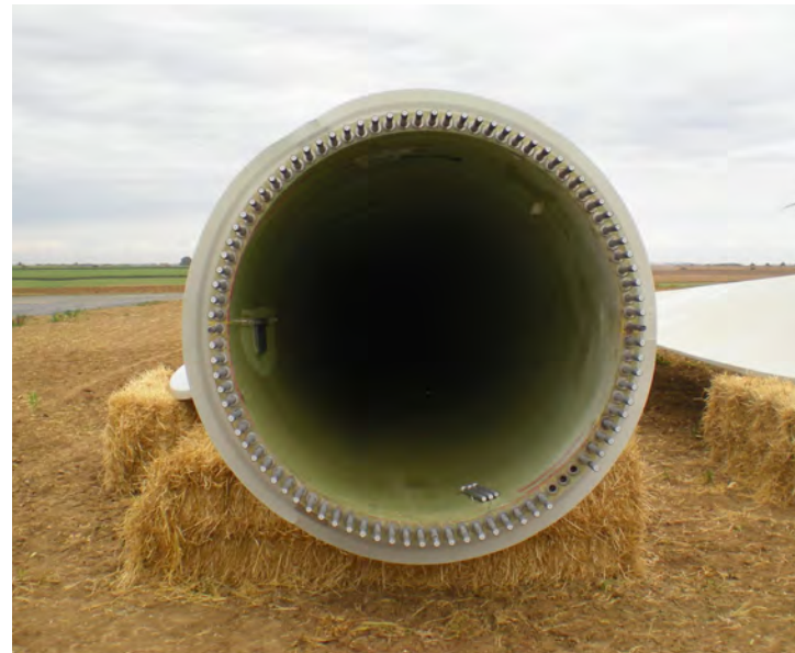
Photographie 26 : Goujons insérés dans les fourreaux, à la base de la pale
