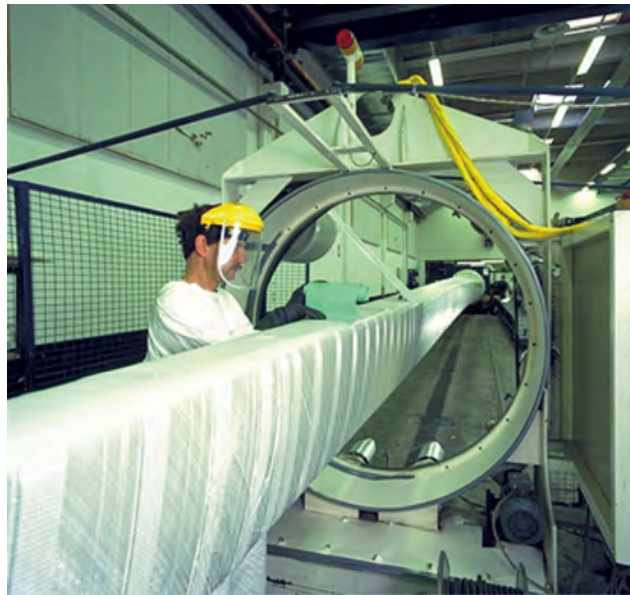
Photographie 24 : Fabrication de la poutre principale
