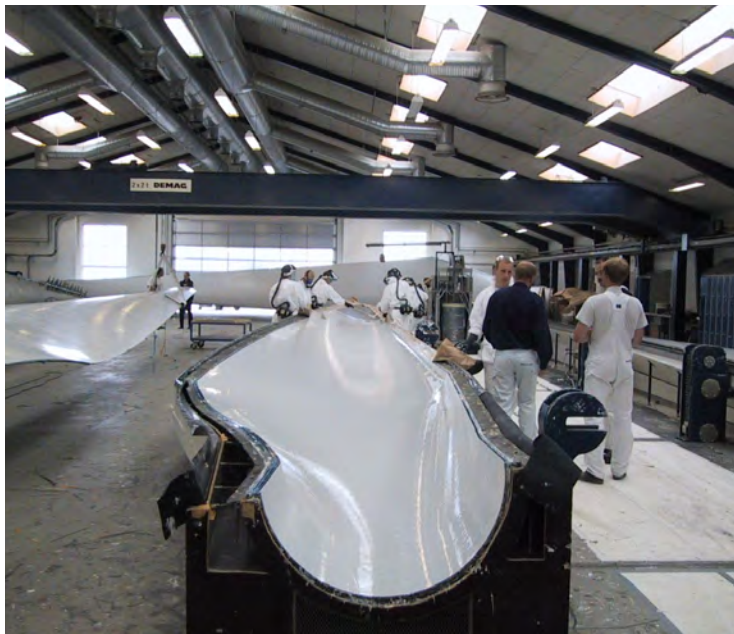
Photographie 25 : Fabrication d'une demi-coque
