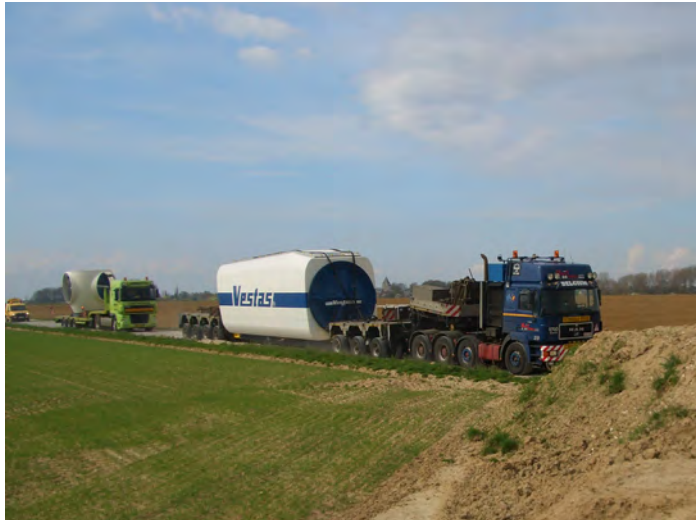
Photographie 15 : Transport du moyeu et de la nacelle
