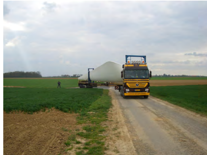
Photographie 18 : Transport d'une pale de 40 m
