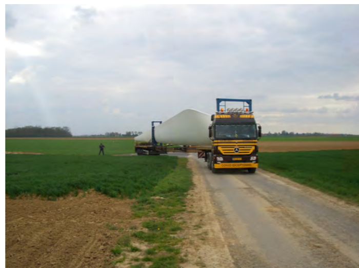
Photographie 6 : Transport d'une pale de 40 m
