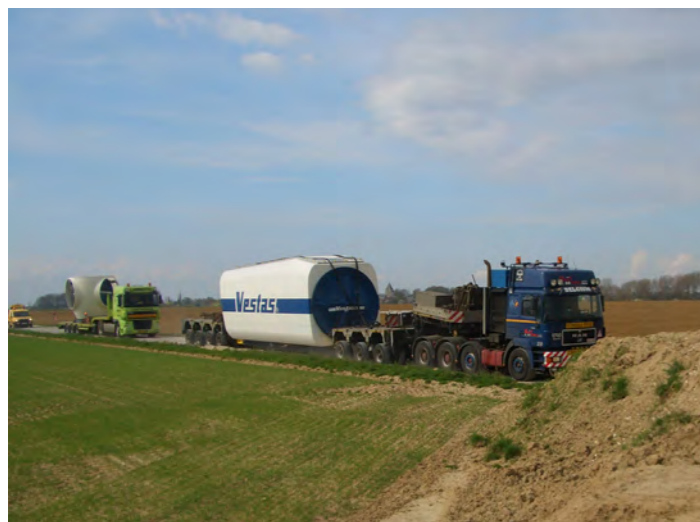
Photographie 4 : Transport du moyeu et de la nacelle
