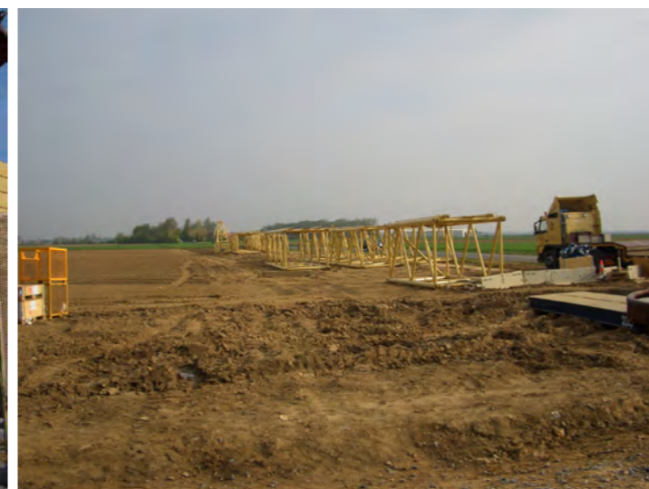
Photographie 15 : Éléments de la flèche d'une grue principale couchés dans une parcelle agricole
