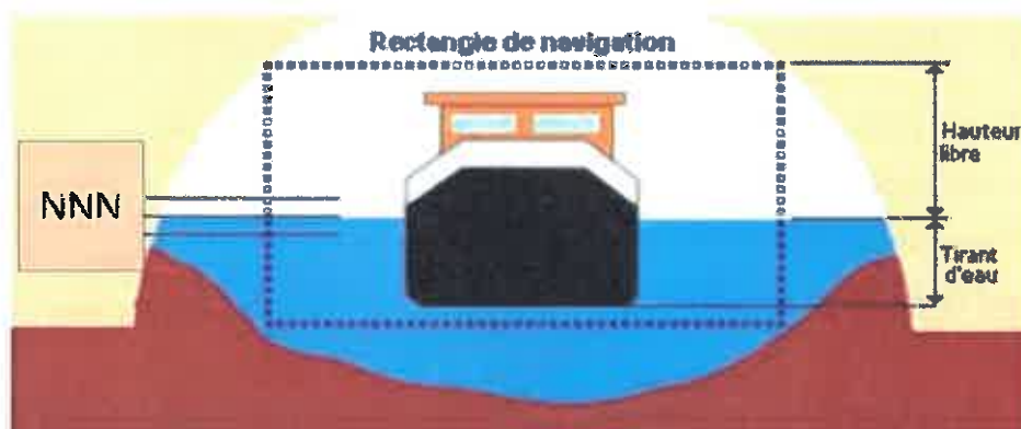
Fig.5 : schéma type du rectangle de navigation
