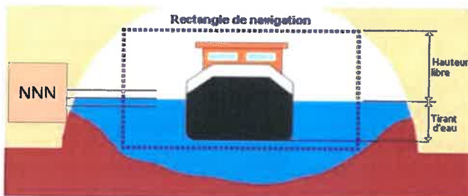
Fig.6 : schéma type du rectangle de navigation
