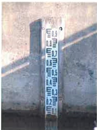
fig.20 : échelle à l'amont
