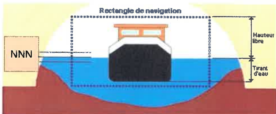
Fig.6 : Schéma type du rectangle de navigation
