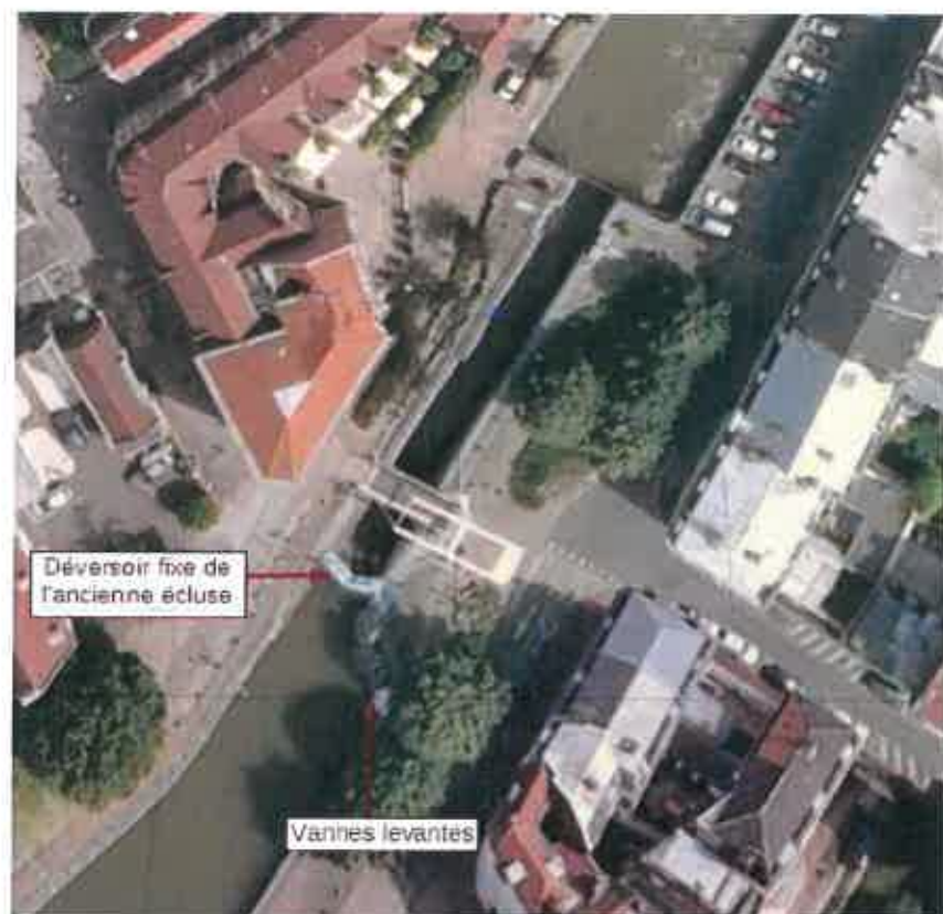
Fig.8 : Situation des ouvrages et de l'écluse
