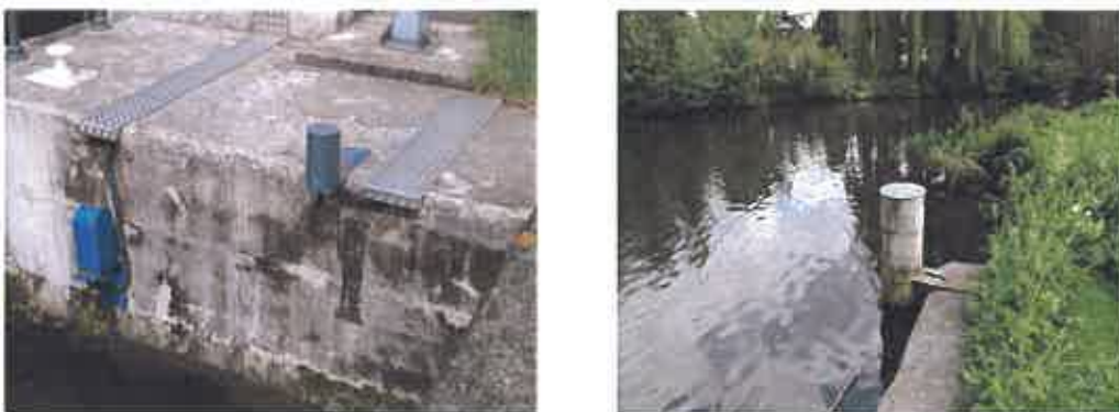
Fig.16: Sonde amont et aval
