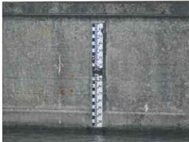
Fig.25 : échelle immédiat au barrage
