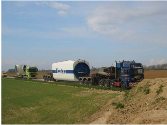
Photographie 17 : Transport du moyeu et de la nacelle
