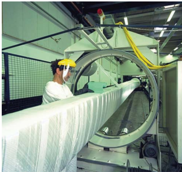
Photographie 26 : Fabrication de la poutre principale
