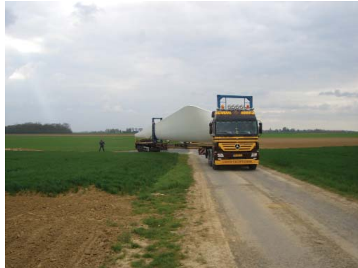
Photographie 20 : Transport d'une pale de 40 m
