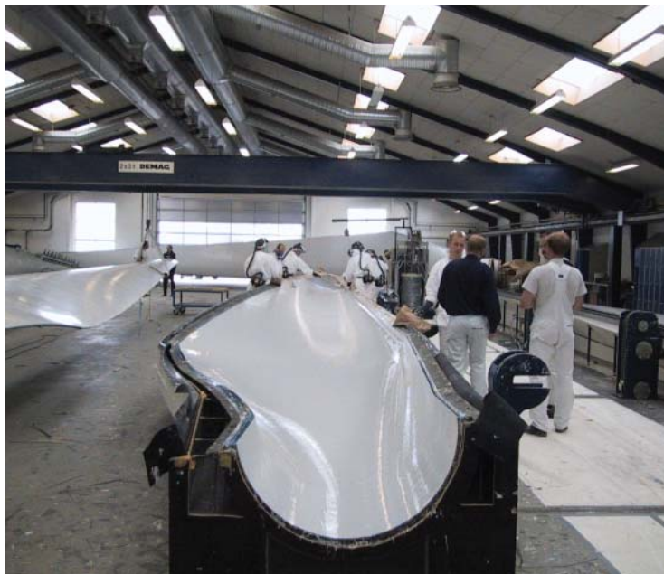
Photographie 27 : Fabrication d'une demi-coque
