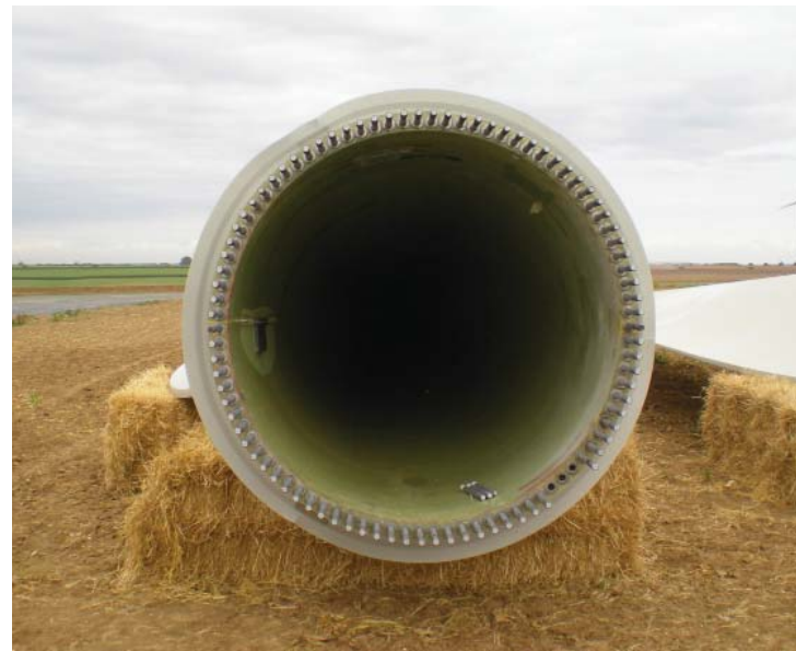
Photographie 28 : Goujons insérés dans les fourreaux, à la base de la pale
