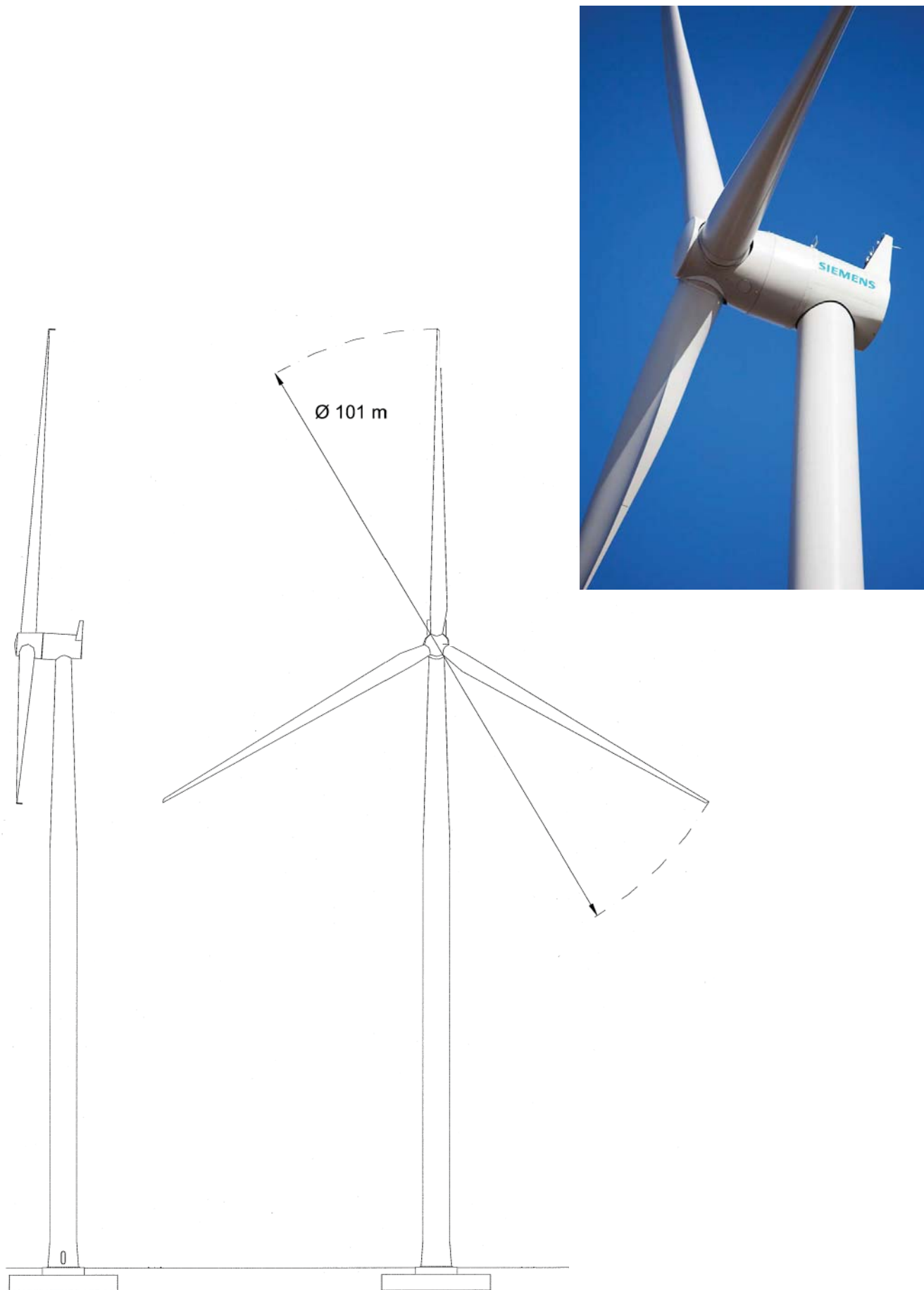
Figure 7 : Représentation de l'éolienne SWT-3.0-101 (source : Siemens)
