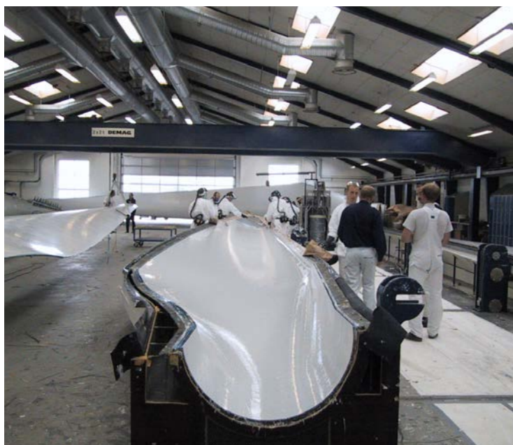
Photographie 27 : Fabrication d'une demi-coque
