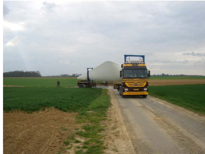
Photographie 20 : Transport d'une pale de 40 m
