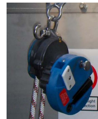
Utiliser le volant pour se soulever.
