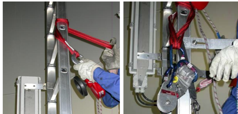
Accrocher le dispositif de descente aux barreaux de l'échelle.
