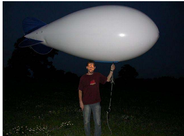
Ballon sonde météorologique utilisé pour des sondages en altitude des déplacements de Chiroptères.
