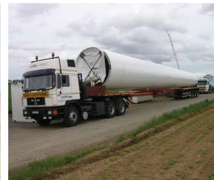
Photographie 23 : Transport des sections de mât 1
