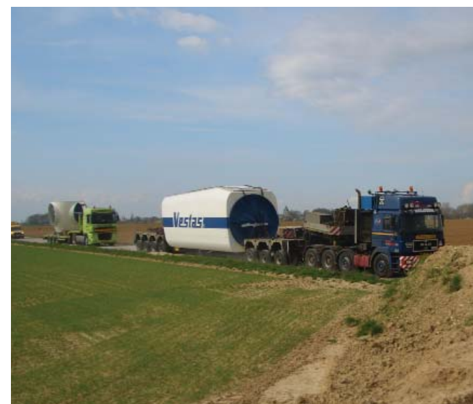
Photographie 22 : Transport du moyeu et de la nacelle 1
