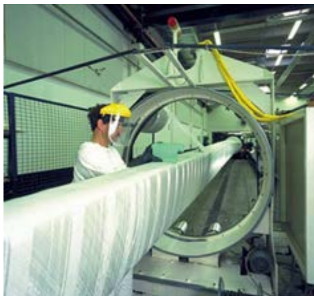
Photographie 28 : Fabrication de la poutre principale
