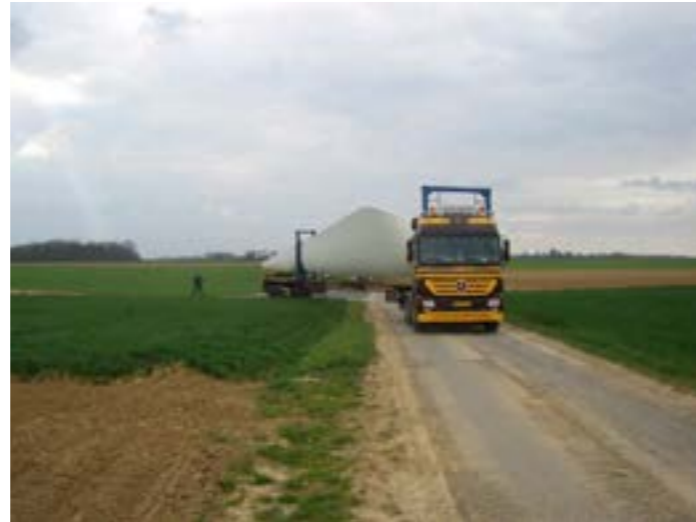
Photographie 22 : Transport d'une pale de 40 m
