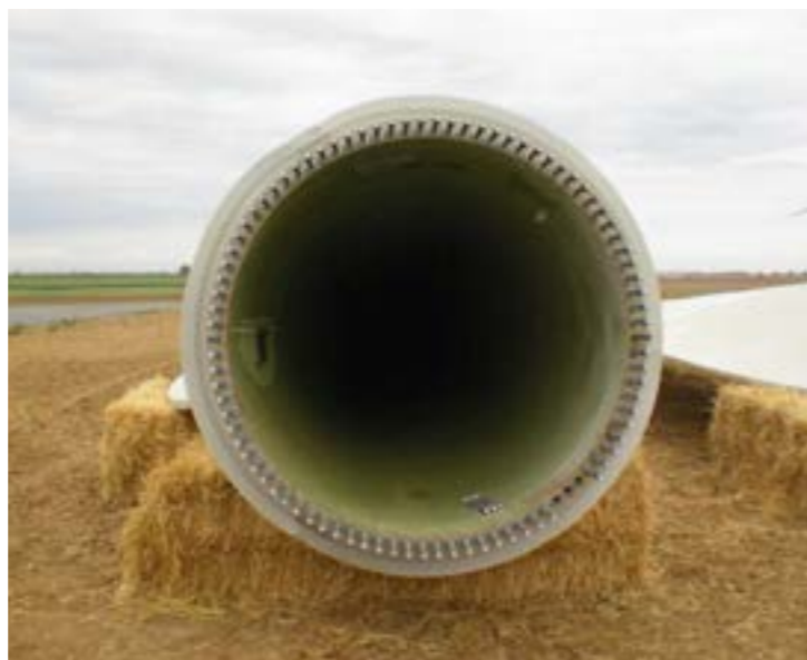
Photographie 30 : Goujons insérés dans les fourreaux, à la base de la pale
