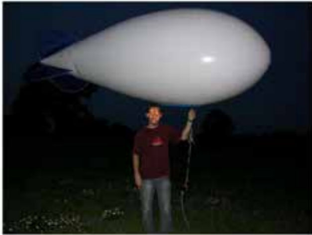
Photographie 76 : Ballon sonde météorologique utilisé pour des sondages en altitude des déplacements de Chiroptères (Source : O2 Environnement)
