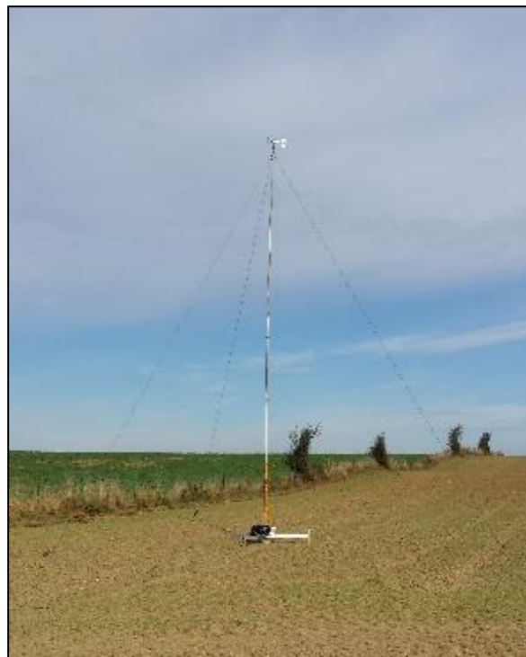
Photographie 44 : Mât météorologique (source : Rapport de mesurage-Acapella)
